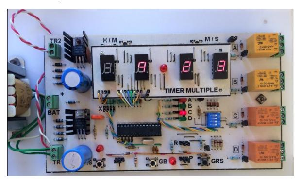
Existe la posibilidad de programar hasta 42 "tiempos a seleccionar", en los cuales las salidas pueden tomar cualquier valor. Una segunda aplicación de este prototipo, otra forma de operar, consiste en un control de intervalos entre un segundo y una hora con opción de repetición del ciclo generado.
