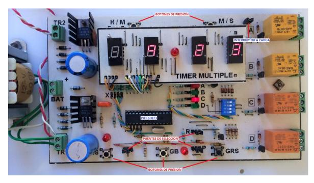
Los puentes citados, son de tipo bipolar, es decir, están formados por tres terminales (postes) en línea, cuyos extremos se conectan a +5V (lado izquierdo) y a tierra (lado derecho); el poste central se une a uno de estos valores mediante el contacto removible.
