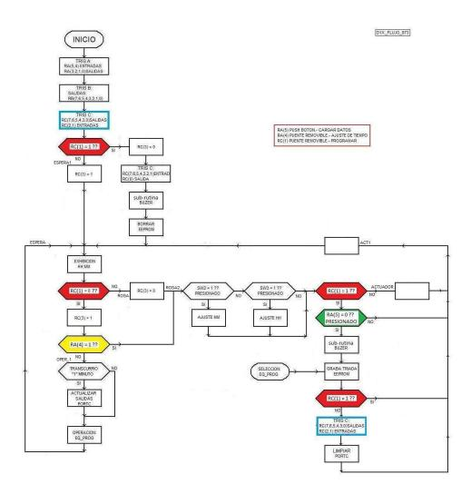
**DESCRIPCIÓN DEL SISTEMA.**- La parte central de este prototipo es el microcontrolador PIC16F873, con 28 pin's y operando a una frecuencia de 4 Mhz, el cual se encarga de controlar todo el sistema.
