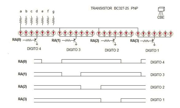
El puerto A, se encarga de polarizar "alternadamente" los cátodos de cada display a través de cuatro transistores PNP de propósito general; el puerto B envía la información del "número" que se exhibirá mediante los segmentos encendidos (a, b, c, d e y f).
